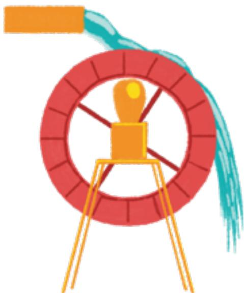
Um volume de água cai nas pás da roda e as movimenta, girando o eixo que mexe junto o objeto ao qual está ligado. Após girar a roda-d'água, a água novamente é lançada no leito do rio, o que causa pouco impacto ao ambiente.
